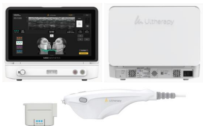
Figura 3.1: Componentes principais do Sistema Ulthera®: unidade de controle (parte superior), peça de mão (canto inferior direito) e transdutor de imagem/tratamento (canto inferior esquerdo) que é inserido no receptáculo da peça de mão.
